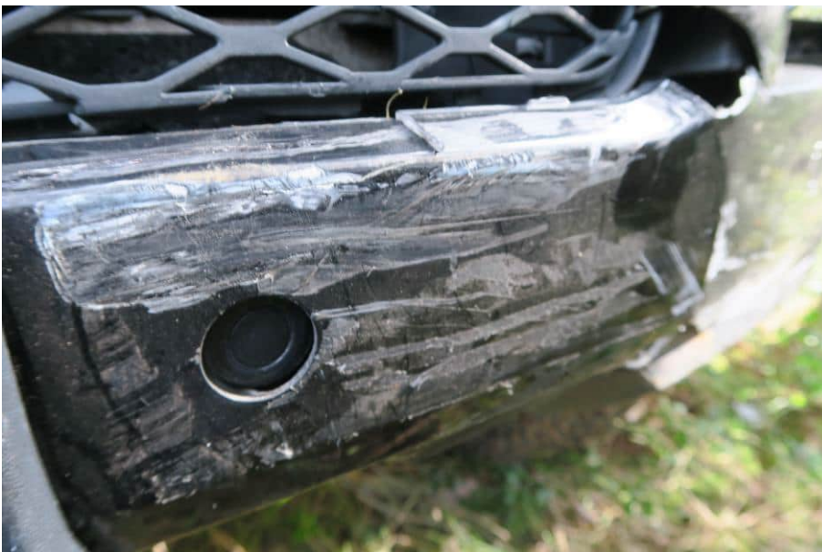
Etupuskurissa, vasemmalla puolen paljon naarmujälkiä.
