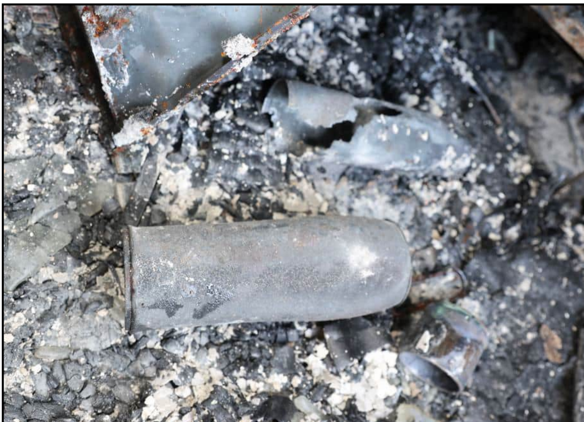
23. Lähikuivissa asunnon olohuoneessa tv-tason lähellä lattialla olleet 1-2 aerosolipulloa. Mahdollisesti hiuslakka tai muu vastaava suihkepullo, jossa propaani-butaani seos paineaineena.
