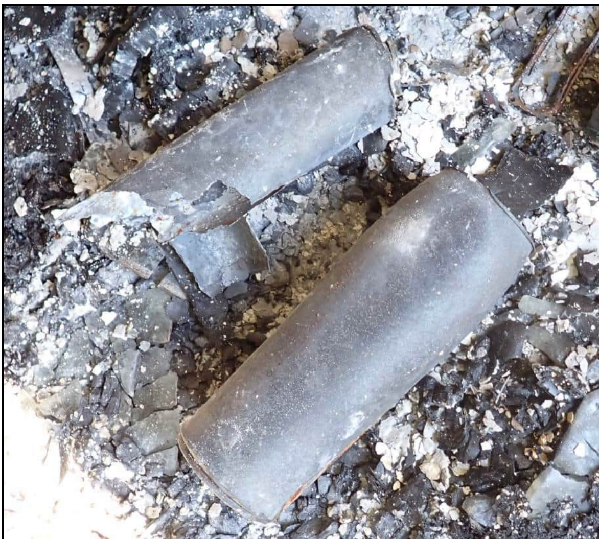
23. Lähikuivissa asunnon olohuoneessa tv-tason lähellä lattialla olleet 1-2 aerosolipulloa. Mahdollisesti hiuslakka tai muu vastaava suihkepullo, jossa propaani-butaani seos paineaineena.
