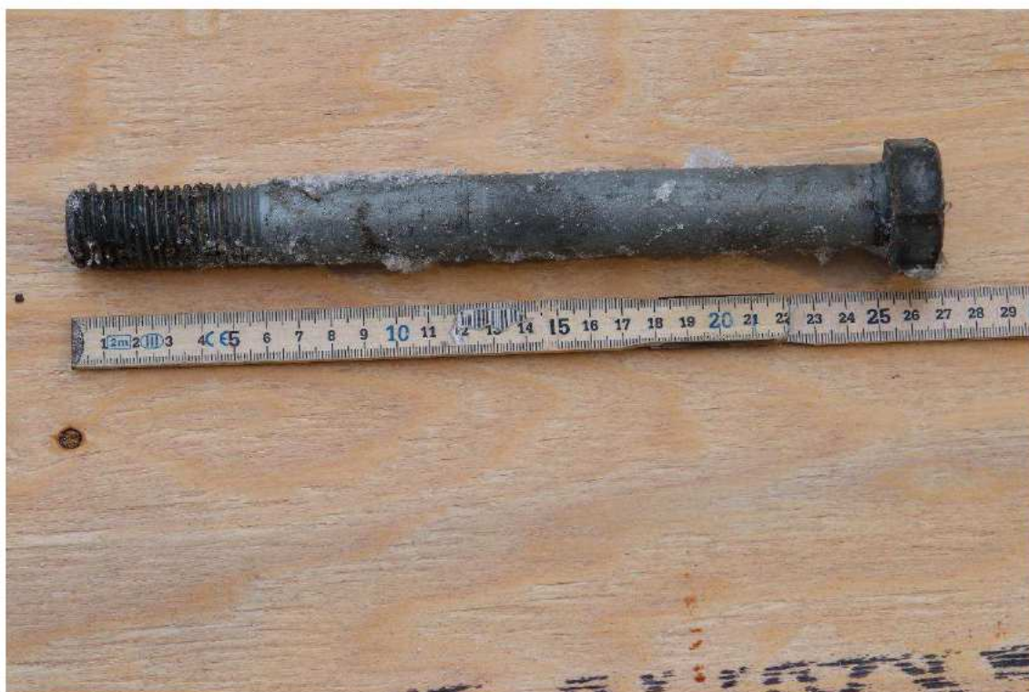
Figur 35. Skruven (G005) som anträffades i hisschaktet.
