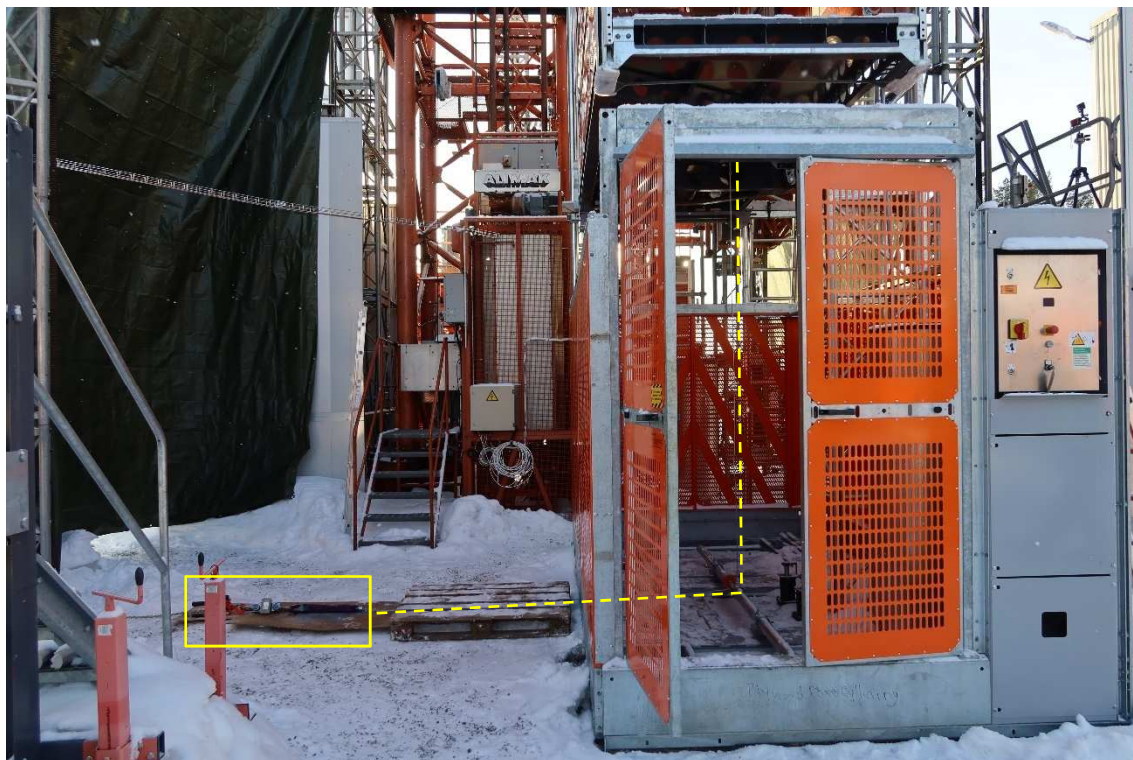
Figur 2. Hisschaktet med konstruktionen för att simulera last i hissen. Den streckade linjen följer den vajer som var fäst på undersidan av hissorgsgolvet. Den gula kvadraten visar spaklyftblocket.
