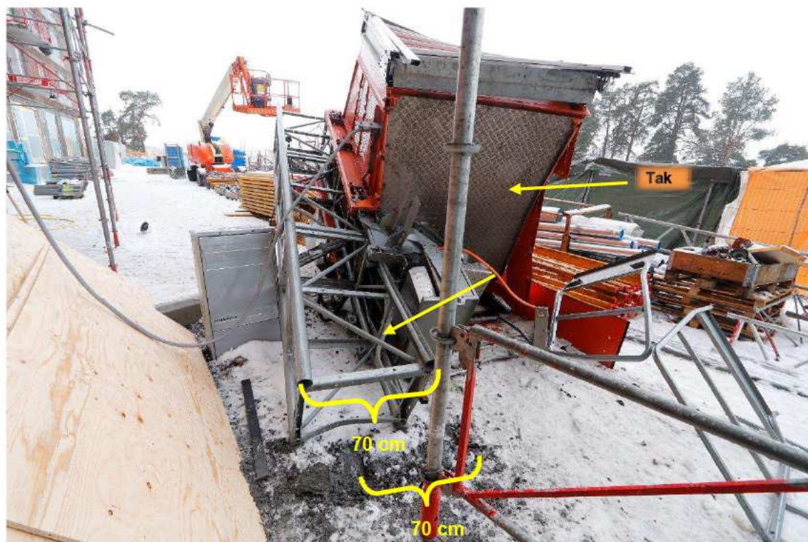
Figur 13. De gula klamrarna visar hur mastens fyrkantsprofil korresponderar med islagsmärken i marken. I översta delen av sektion 21 ses även böjda stag.
