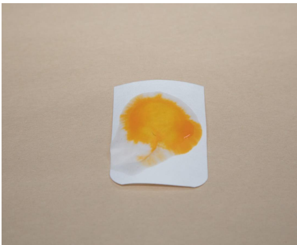
Kuva 5. Testitulos valokuvattuna välittömästi sen jälkeen, kun imupaperille on tipputettu 3 tippaa reagenssiainetta. Imupaperille ei muodostu punaisen purppuraa väriä.
