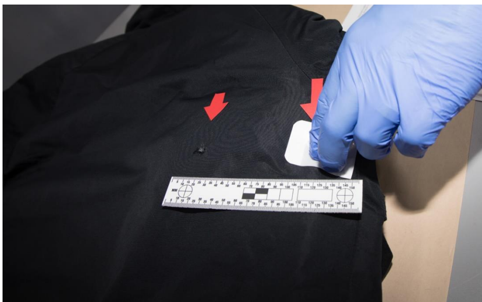
Kuva 2. Laimennetulla etikkahapolla kostutettua imupaperia painetaan tutkittavalle materiaalille, takin selkäpuolella olevan kainalonpuoleisen reiän päälle.
