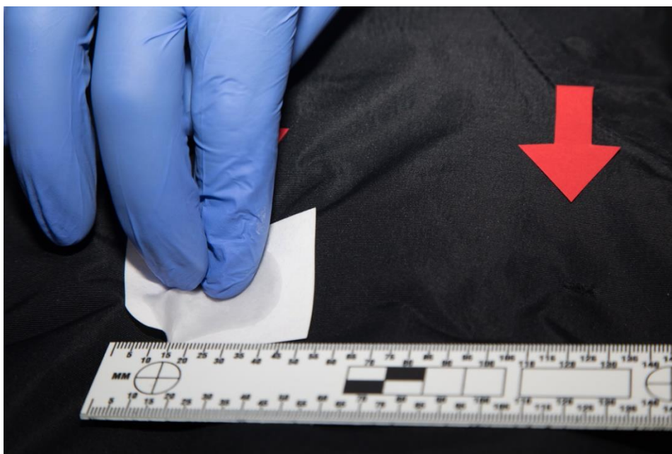
Kuva 4. Laimennetulla etikkahapolla kostutettua imupaperia painetaan lähempänä takin keskiosaa olevaan reikään.
