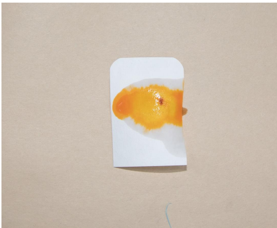
Kuva 3. Testitulos valokuvattuna välittömästi sen jälkeen, kun imupaperille on tipputettu 3 tippaa reagenssiainetta. Imupaperille muodostunut punaisen purppura piste.
