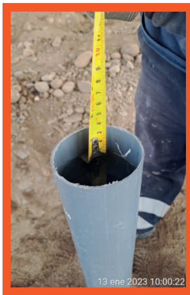
PRUEBAS HIDRAÚICAS DE DESAGÜE - ESTANQUEIDAD
