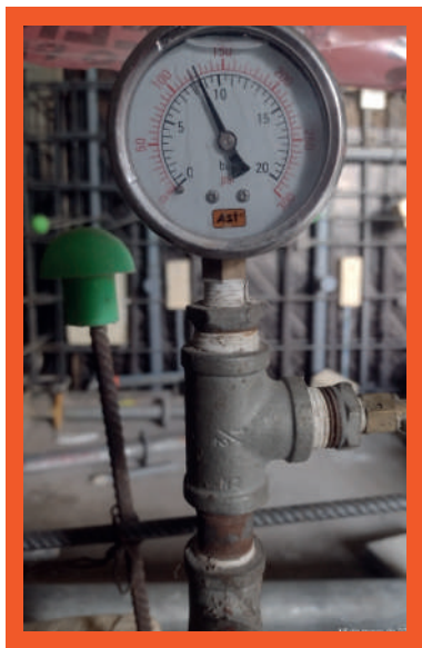
PRUEBAS HIDRAÚICAS DE AGUA - DE PRESIÓN
