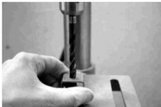
Drilling the die holes.
