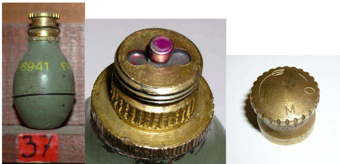
Bild 1 Spränghandgranat M50P1, handgranattändare M50 samt skyddshuv
