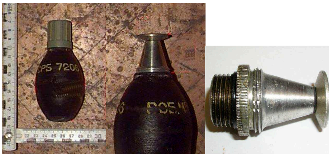
Bild 2 Spränghandgranat M50P2 med skyddshuv, utan skyddshuv samt handgranattändare UM-69
