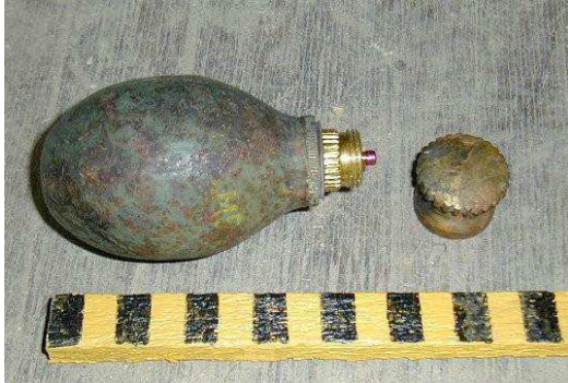
Bild 4 Språnghandgranat M52,R med handgranattändare M50
