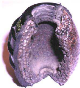
Bild 3 Genomskuren handgranatskropp med stålkulorna exponerade
