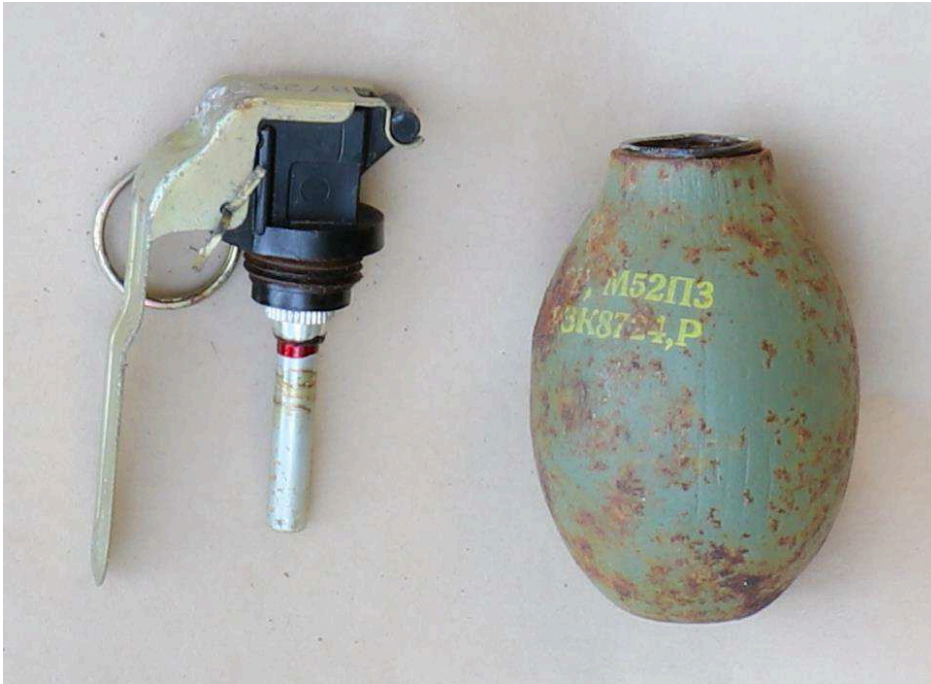
Figur 7. Handgranat (BG91162-1) av modell M52. Handgranaten är delad och lagd på ett papper.
