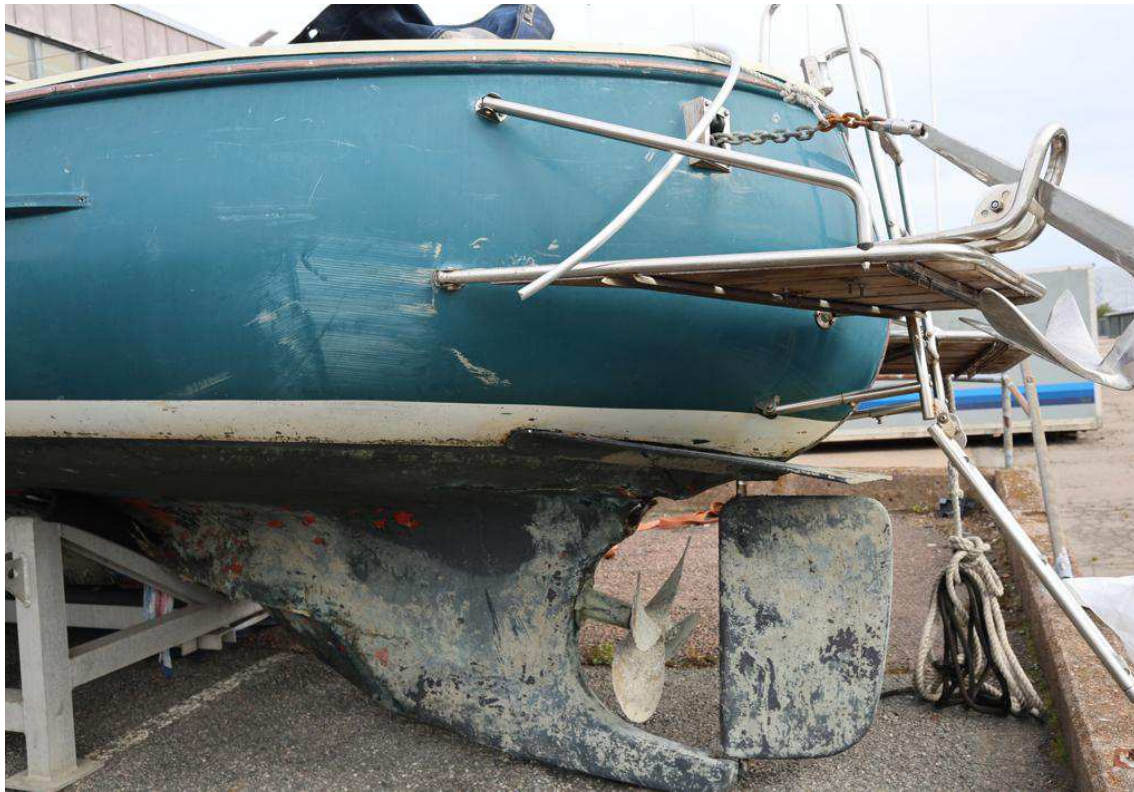
Figur 10. Närbild på skadan på babordssidan, närmast aktern.
