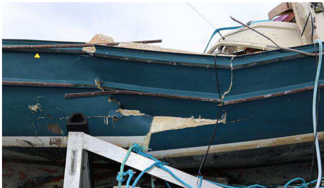
Figur 12. Närbild på den utåtbuktande skadan på styrbordssidan.
