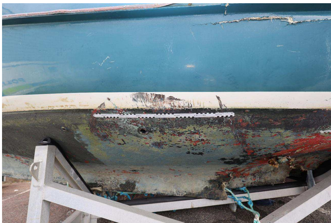
Figur 9. Närbild på den svarta färgavsättningen på babordssidan.
