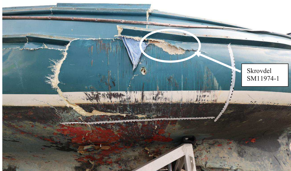
Figur 8. Närbild på skadeområdet med svart färgavsättningen som fanns på mitten av babordssidan. Platsen där färgflagan (SM11974-1) säkrades är markerad i bild.
