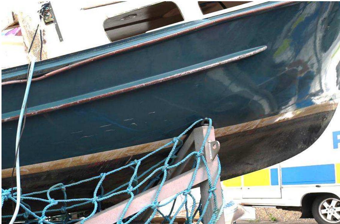
Figur 13. Närbild på skador i ytskiktet på skrovets styrbordssida, närmast fören.
