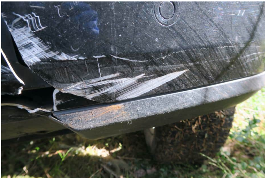
Keulassa, etupuskurinvasemmassa alalaidassa halkeamia ja naarmuja.
